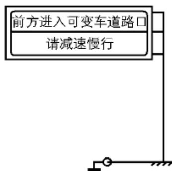
第二级应该在可变车道的车道转化处设置车道划分标志，以提醒驾驶员前方道路的可变车道的位置，使得驾驶员能够及时的变化车道，具体如下图所示。
